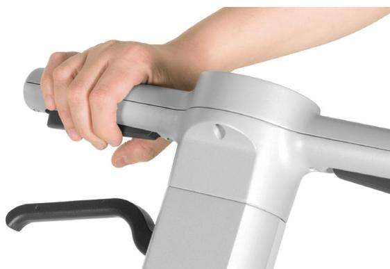
Accrochage et décrochage de la brosse pratique et rapide : il suffit d'appuyer trois fois sur les leviers de présence opérateur et de confirmer le décrochage sur l'écran de Vispa EVO pour retirer la brosse.
