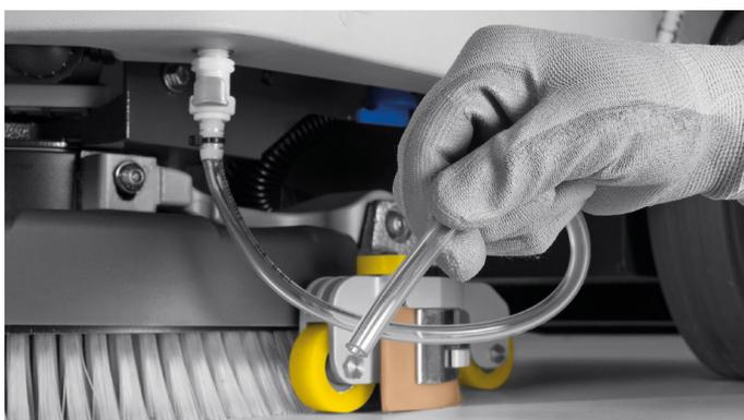
Même le déchargement de l'eau présente dans le réservoir de solution peut être effectué rapidement et facilement grâce au tuyau de déchargement spécial qui peut être accroché à l'avant de l'autolaveuse.
